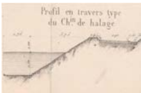
104- Profil en travers type du chemin de halage sur le canal de l'Ourcq, 1880.
