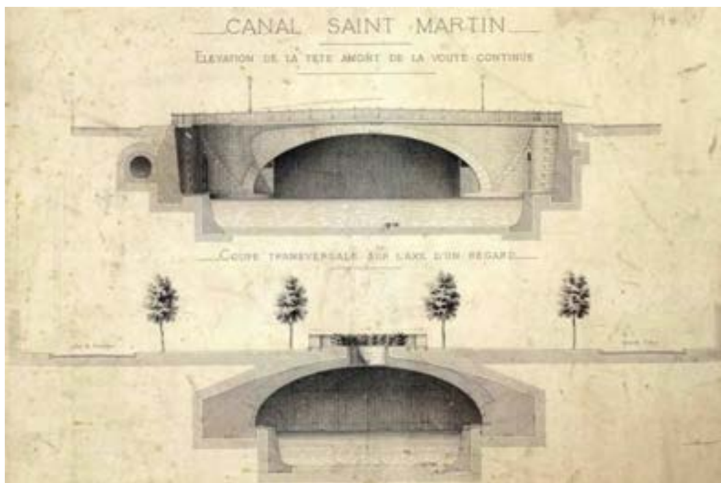
21- Élévation de la tête amont de la voûte continue du canal Saint-Martin et coupe transversale sur l'axe d'un regard, 1863.
