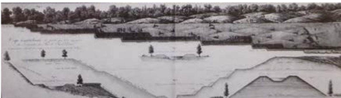
46-2- Coupe longitudinale des fouilles par levées successives dans la tranchée des bois de Saint-Denis et projection verticale des rampes servant à l'enlèvement des déblais, vers 1802-1815.
