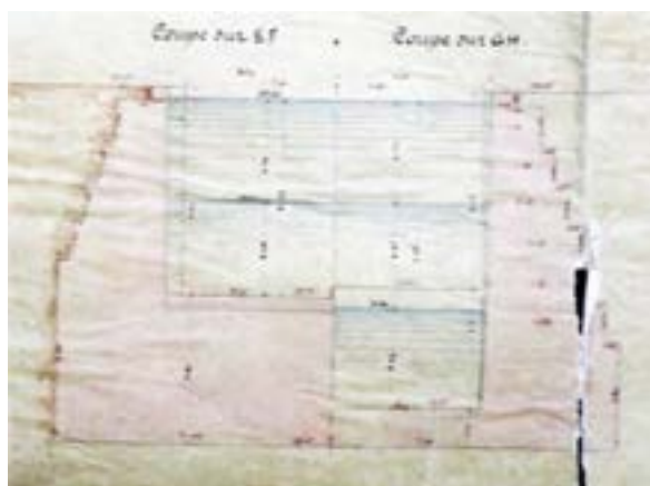
10- Coupes en travers au niveau des écluses n° 7 et n° 8 du canal Saint-Martin, 1859.
