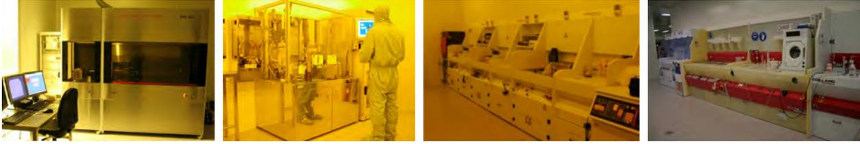
FIGURE 2.1 – Photographies de différentes zones de la salle blanche. De gauche à droite : zone d'écriture laser, zone de photographie automatique, zone de photolithographie manuelle et zone chimie. La couleur jaune des trois premières photos est réelle. Elle est due à la lumière inactinique utilisée dans ces zones (c'est-à-dire qui n'a pas d'effet photosensible, dans notre cas une lumière sans UV)
