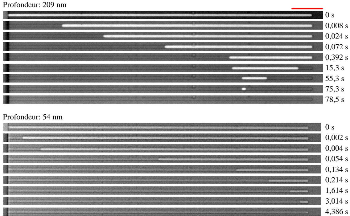
FIGURE 3.18 – Comparaison de la cinétique d’imbibition de nanocanaux en impasse de 209 nm et 54 nm de profondeur. L’échelle de longueur représente 100  $\mu\text{m}$ .
