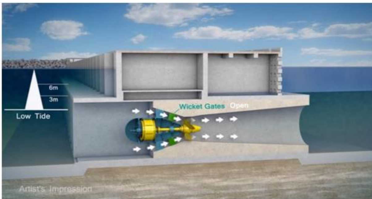
Figure 31 : Coupe d'une usine marémotrice avec turbine bulbe
