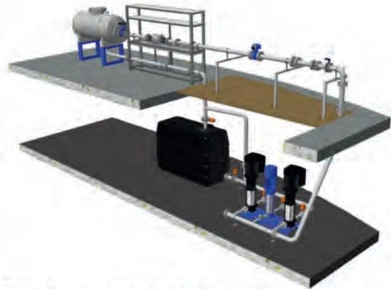
Banc d'essai pour la mini-hydraulique
