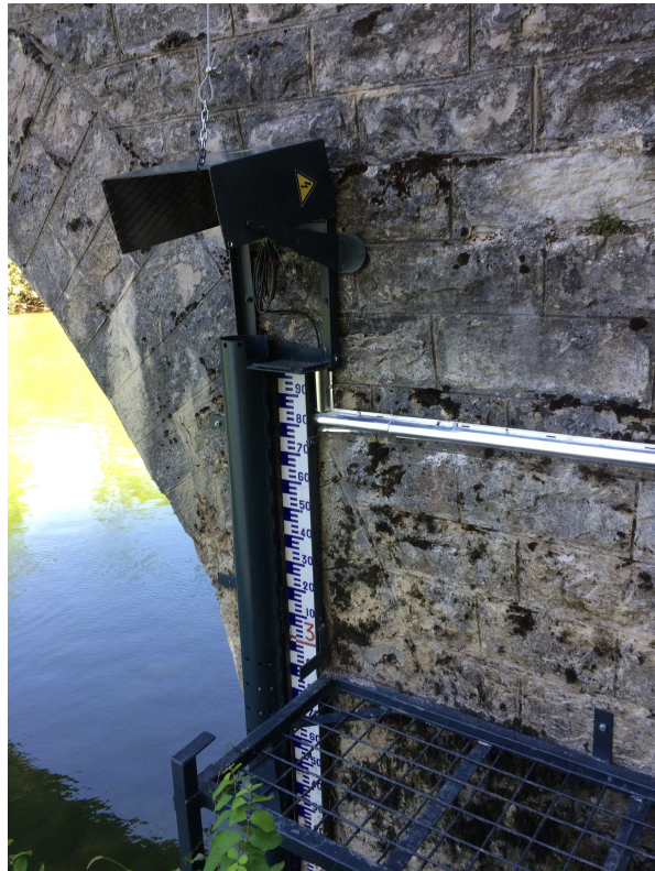
Implantation du capteur qualité/O 2
