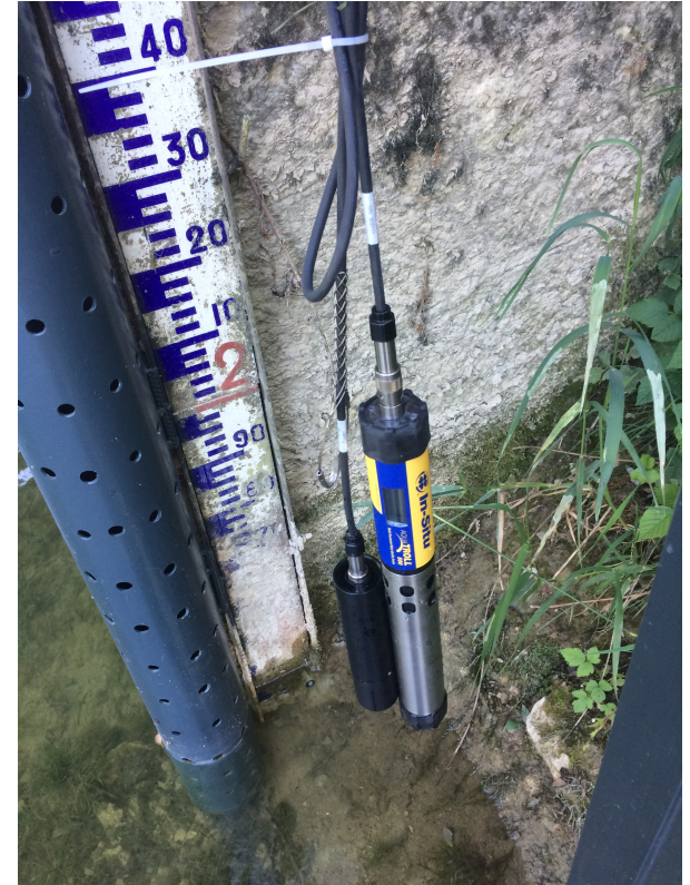
Capteur qualité/O 2 (taille réelle : 592 mm x 47 mm)
