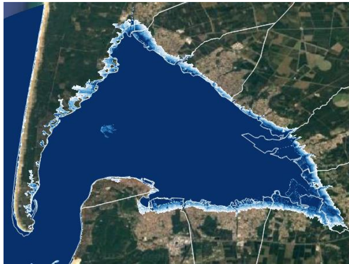
Figure 3 : Illustration de la base de données : (Gauche) Niveau marin (en NGF) maximum modélisé au marégraphe d'Eyrac pour les 30 tempêtes les plus intenses sur la gamme de niveau astronomique à Eyrac considéré. Le terme NS indique les scénarios non simulés. (Droite) Carte des hauteurs d'eau atteintes à terre pour le scénario le plus extrême sur l'ensemble des 10 communes littorales du Bassin d'Arcachon.
