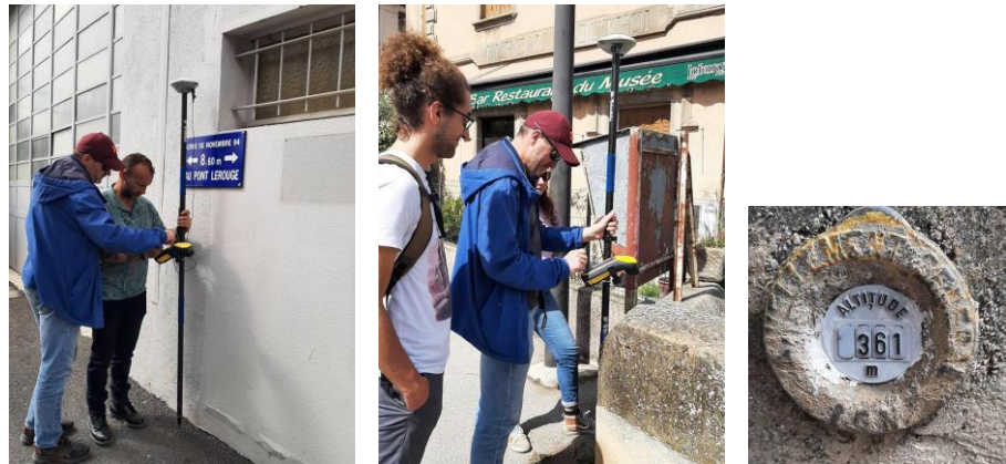
Figure 4 : Formation pour le relevé et nivellement de repères de crues entre le SPC GTL et le SMBVTAM , à Millau, de gauche à droite : Nivellement relatif avec un GNSS - Calibration du GNSS sur un point géodésique - Repère de nivellement utilisé
