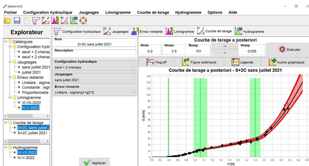
Figure 4 : Interface du logiciel open-source BaRatinAGE pour quantifier l’incertitude des courbes de tarage et hydrogrammes
