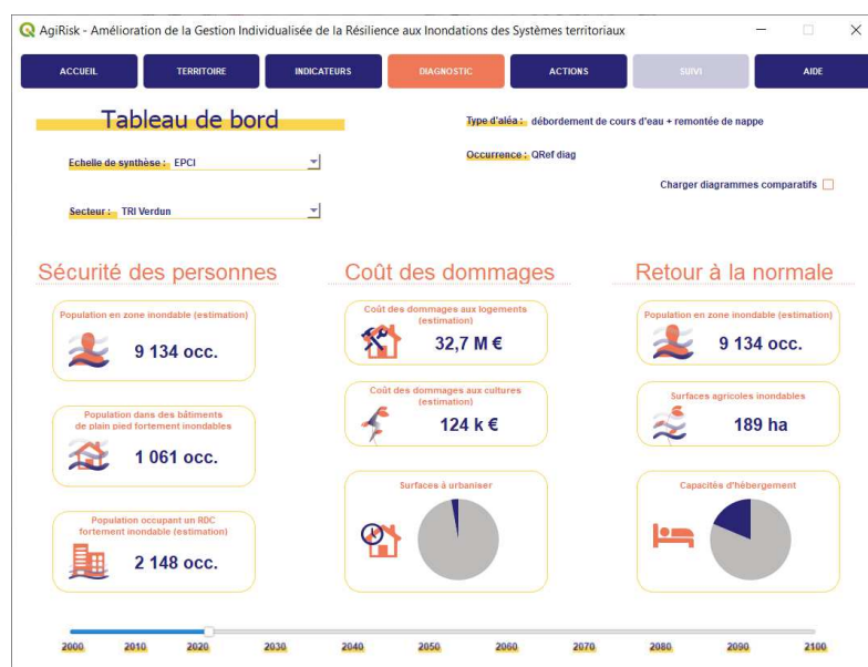
Figure 6: Tableau de bord de l'outil AgiRisk (le coût des dommages dépend de la hauteur d'eau, de la durée de submersion, de l'emprise du bâtiment et est calculé à partir des courbes de dommages du guide AMC en prenant en compte la typologie des bâtiments impactés)
