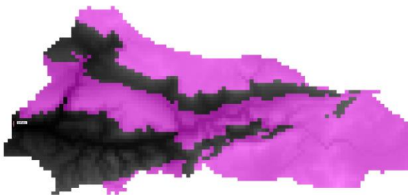
Figure 7 Bassin hydrogéologique de la Sorgues : différenciation des valeurs des paramètres du modèle sur la partie socle (en noir) de la partie karstique (en rose, source BD LISAH).
