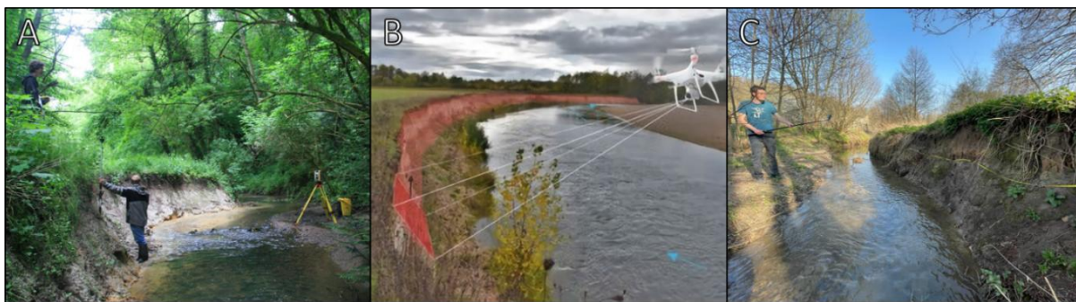
Figure 2. Photographies des différents protocoles d'acquisition. A : Photogrammétrie SfM pédestre sur la Mérantaise. B : Photogrammétrie SfM par drone RTK sur l'Armançon. C : Acquisition LiDAR sur le Morbras.
