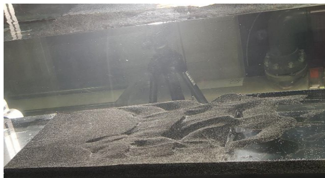
Figure 1 : Essais d'érosion sur sédiments modèles calibrés au sein de la Plateforme Hydrodynamique Environnementale
