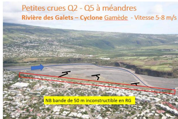
Figure 2: Bras vis surcreusé pendant le cyclone Gamède 2007, village de la Rivière des Galets
